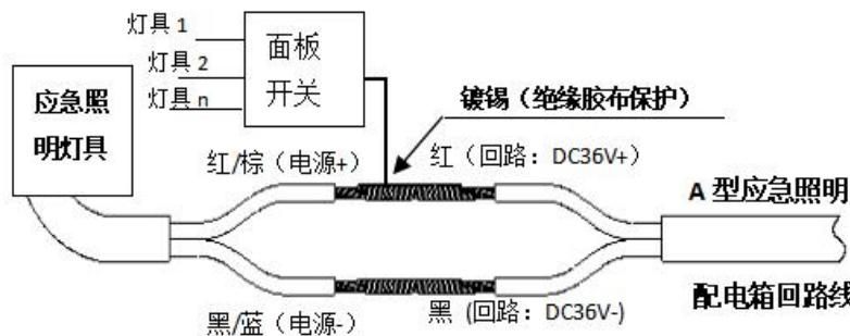
灯具出厂自带一根强启线（灰色），灯具如需兼做日常照明，可通过在回路正极上加装开关来实现控制，如果单个开关要控制多个灯具则将各灯具强启线并联至开关下端，如上图所示。
