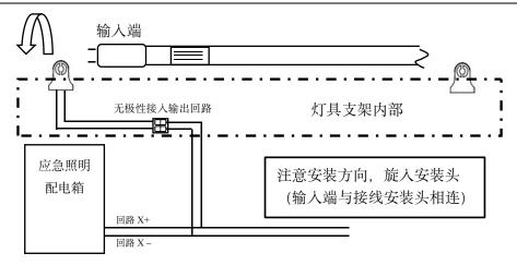
灯具单侧供电,安装时应注意灯具的输入端(产品标签侧)应与灯架的接线端安装头相连接(灯具输入端无极性)。
