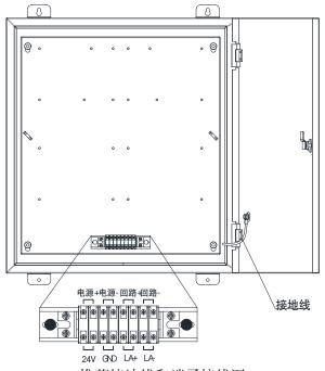
推荐接地线和端子接线图
